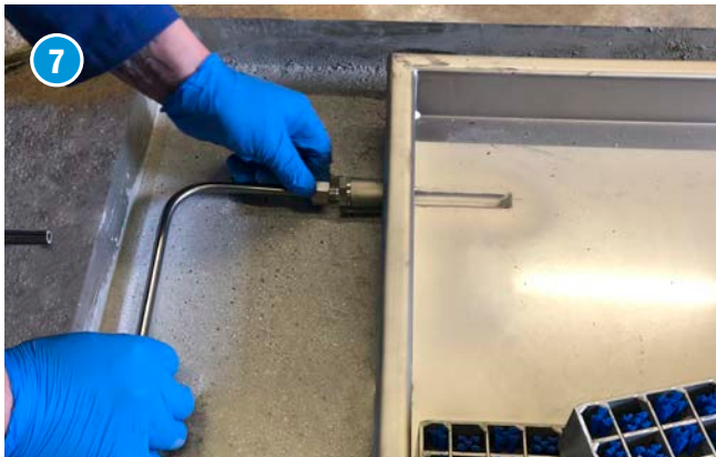
7 Mediumzufuhr anschließen. Attach liquid supply. Watertoevoer aansluiten. Connectez l'alimentation d'eau.
