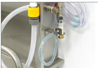
Voorzien van ejecteur t.b.v. dosering desinfectiemiddel
